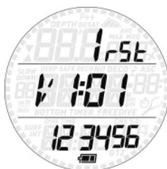
Questo sottomenù fornisce informazioni sui componenti hardware e software di Smart Apnea e sullo stato della batteria (due segmenti all'interno del simbolo della batteria indicano che la carica è buona, un segmento indica che la carica è bassa ma l'orologio funziona come computer da immersione, un segmento lampeggiante indica che la carica non è sufficiente per il computer da immersione).
