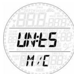
È possibile scegliere tra sistema metrico (profondità in metri, temperatura in °C) e imperiale (profondità in piedi, temperatura in °F).
