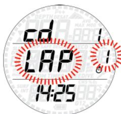
Impostare il valore nello stesso modo usato per i minuti; a questo punto compaiono **LAP** (tempo parziale) e un numero sulla riga centrale, entrambi lampeggianti. Premere il pulsante superiore per aumentare il numero e quello inferiore per passare direttamente a **cnt**. Tenere premuto il pulsante superiore per confermare il valore e uscire dalla modalità di impostazione.
