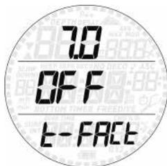
L'intervallo di superficie minimo è definito come la durata dell'immersione precedente moltiplicata per il fattore t. Il fattore t può essere impostato tra 1 e 7 in incrementi di 0,5.
