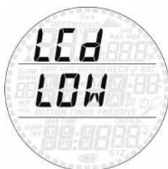
Questa funzione consente di alternare la velocità di aggiornamento del display tra bassa e alta. L'impostazione predefinita è bassa: ciò consente di consumare meno energia, ma in presenza di luce molto intensa si può osservare un lieve sfarfallio del display. Passando all'opzione di velocità alta si riduce lo sfarfallio, ma la durata della batteria diminuisce di circa il 30%.
