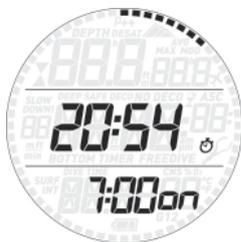
Quando viene visualizzato il secondo orario, tenendo premuto il pulsante superiore si possono alternare l'orario principale e quello secondario.
