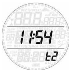
Smart Apnea dispone di una modalità standby: nel caso lo si utilizzi solo per le immersioni, è possibile attivare tale modalità per ridurre il consumo della batteria. Per uscire dalla modalità standby, premere qualsiasi pulsante.
