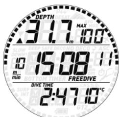
Premere il pulsante superiore per visualizzare la prossima sessione o tenerlo premuto per accedervi: per ciascun tuffo singolo della sessione sono mostrati la profondità massima e il numero sequenziale del tuffo nella parte superiore, le velocità massime di discesa e risalita (in alternanza) e il tempo di
