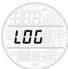
Smart Apnea può registrare i profili di circa 20-30 ore di immersione, a seconda del numero di tuffi per sessione e della durata di ciascuno di essi, a un intervallo di rilevamento di 1 secondo. Utilizzando la clip USB facoltativa, le informazioni possono essere trasferite a un PC tramite il software Dive Organizer oppure a un Mac tramite il software Divers' Diary. Inoltre, Smart Apnea può visualizzare la maggior parte delle informazioni direttamente sul display.
