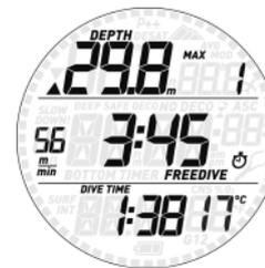
Premendo il pulsante superiore, il display visualizza per 5 secondi la profondità massima e il numero di tuffi della sessione nella riga superiore, le velocità massime di risalita e discesa della sessione (in alternanza) e l'intervallo di superficie nella riga centrale, il tuffo più lungo e la temperatura minima della sessione nella riga inferiore. Inoltre, per meglio
