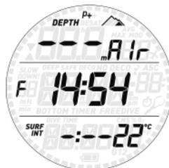
Il display pre-immersione visualizza il fattore P, le impostazioni di altitudine, l'ora del giorno, l'intervallo di superficie dall'ultima immersione e la temperatura. Se è stato impostato il nitrox, viene visualizzata la percentuale di O<sub>2</sub> e la MOD corrispondente. Una piccola S (acqua salata) o F (acqua dolce) a sinistra della riga centrale indica il tipo di acqua.
