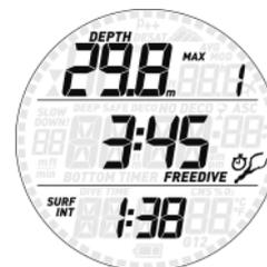
Premendo il pulsante superiore, il display visualizza i seguenti dati relativi alla sessione di immersione: la profondità massima nella riga superiore, il tempo massimo di immersione in quella centrale e la temperatura minima nella riga inferiore.
