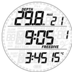
Tenere premuto il pulsante superiore per entrare nella sessione e visualizzare la profondità massima e il conteggio sequenziale dell'immersione in alto, il tempo di immersione al centro, l'intervallo di superficie prima dell'immersione e la temperatura minima in basso.
