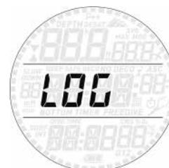
Smart è in grado di registrare i profili di circa 35 ore di immersione, con intervalli di rilevamento ogni 5 secondi. Utilizzando la clip USB facoltativa, le informazioni possono essere trasferite a un PC tramite il software Dive Organizer oppure a un Mac tramite il software Divers' Diary. Inoltre, Smart può visualizzare la maggior parte delle informazioni direttamente sul display.
