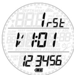
Questo sottomenu fornisce informazioni sui componenti hardware e software di Smart e sullo stato della batteria (due segmenti all'interno del simbolo della batteria indicano che la carica è buona, un segmento indica che la carica è bassa ma l'orologio funziona come computer da immersione, un segmento lampeggiante indica che la carica non è sufficiente per il computer da immersione).
