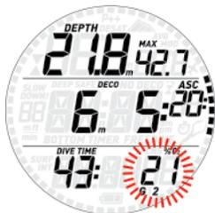
Premere il pulsante superiore mentre questo valore lampeggia per iniziare il cambio miscela: la percentuale di ossigeno di G2 comincia a lampeggiare in sostituzione di quella di G1 e nell'angolo superiore sinistro le lettere MOD e il relativo valore per G2 compaiono lampeggiando.
