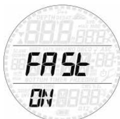
Una risalita si definisce eccessivamente rapida (incontrollata) quando si mantiene una velocità di 12 m/min o superiore per oltre due terzi della risalita. Questo è applicabile solo a immersioni condotte a una profondità superiore a 12 m. In tal caso, a causa del potenziale di formazione di bolle nocive, Smart blocca il computer per 24 ore in modo da dissuadere l'utente dall'immergersi nuovamente. In questo menu, è possibile disattivare il blocco del computer in caso di eccesso velocità.
