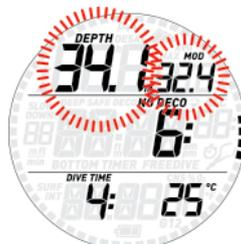
L'allarme continua fino a che la profondità non viene diminuita in modo sufficiente a riportare la  $ppO_2$  entro il limite impostato.
