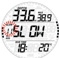
Se la velocità di risalita supera i 12 m/min a una profondità inferiore a 12 m, compare il messaggio **SLOW DOWN!** e il valore della velocità lampeggia. Se una velocità superiore a 12 m/min è mantenuta per due terzi o più della profondità alla quale l'allarme era stato attivato per la prima volta, Smart la considera una violazione delle norme d'immersione e sul display viene visualizzato il messaggio **SLOW DOWN!** fisso.
