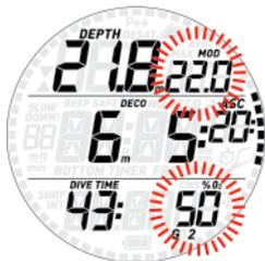
Tenere premuto il pulsante superiore per confermare il cambio a G2 o premere il pulsante inferiore per annullare il cambio miscela e rimanere con l'impostazione di G1. In entrambi i casi la concentrazione di ossigeno impostata viene visualizzata come valore fisso nell'angolo inferiore destro dello schermo ed entro 20 secondi il tempo di risalita viene
