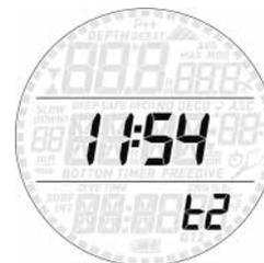
Smart dispone di una modalità standby: nel caso lo si utilizzi solo per le immersioni, è possibile attivare tale modalità per ridurre il consumo della batteria. Per uscire dalla modalità standby, premere qualsiasi pulsante.
