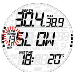
A immersione completata, se si volesse eseguirne un'altra, Smart funzionerà solo come profonditàmetro e timer (modalità profonditàmetro) e sullo schermo verrà visualizzato il messaggio **SLOW DOWN!** per tutta la durata dell'immersione.
