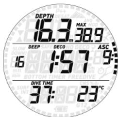
Per le soste **DECO**, poiché la durata è in funzione della profondità esatta, sono mostrati solo i minuti.
